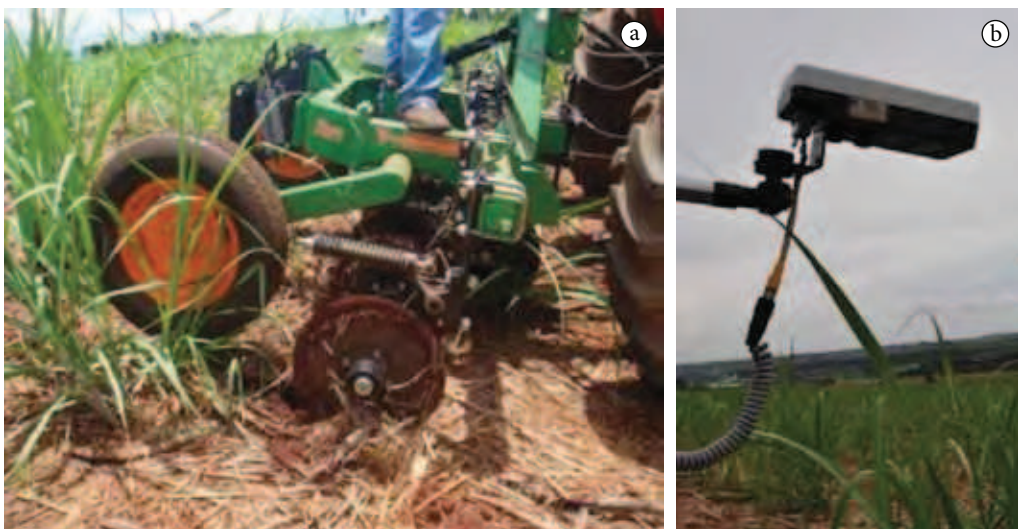
Figura 2. Sensores de medição: a) condutividade elétrica do solo - Veris; b) índice de vegetação - Crop Circle
