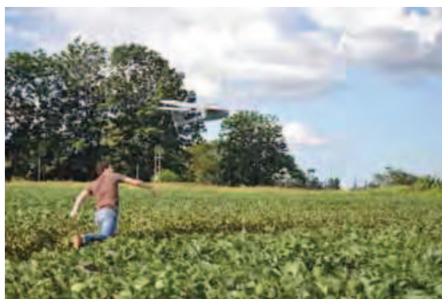
Figura 22. Forma de decolagem mais simples para um VANT agrícola. Fonte: http://blog.cimmyt.org/sky-walker-advances-phenotyping-in-southern-africa/ . Acesso dezembro 2013).
