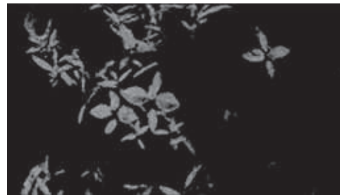
Figura 10. Exemplo de resultado com aplicação da operação de limiarização como preparação das etapas subsequentes para o reconhecimento de plantas invasoras.
