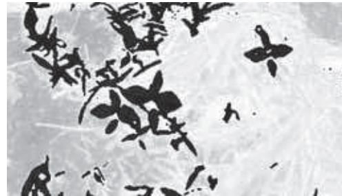
Figura 9. Exemplo de resultado da aplicação do filtro de mediana de tamanho 3x3 (operação de convolução no domínio espacial) aplicado na imagem resultante da operação da subtração das componentes (G-R), onde houve suavização com a eliminação de ruídos de baixa frequência, como parte das operações da etapa de pré-processamento em segmentos de imagem obtida em campo experimental.
