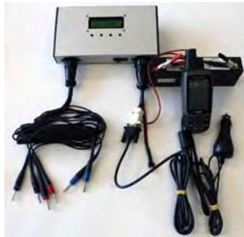
**Figura 5.** Sistema protótipo de medida de condutividade elétrica.
