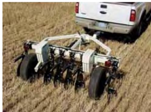
**Figura 2.** Sistema de medida condutividade elétrica aparente, V3100.
