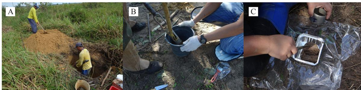
Figura 2. A - Abertura das trincheiras; B - Coleta de solo com trado holandês; C - Amostras indeformadas para densidade.
