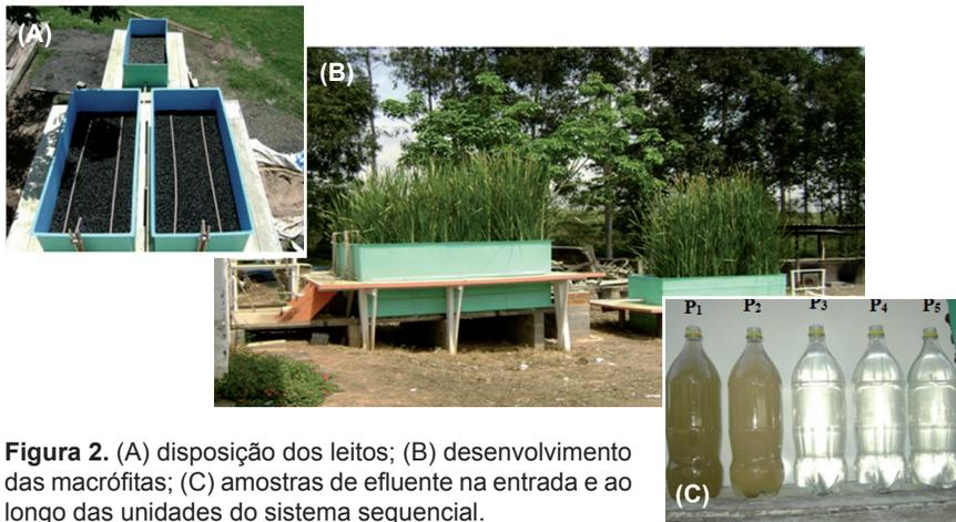
**Figura 2.** (A) disposição dos leitos; (B) desenvolvimento das macrófitas; (C) amostras de efluente na entrada e ao longo das unidades do sistema sequencial.
