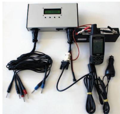
Figura 4. Sistema de medida de condutividade elétrica aparente do solo.
