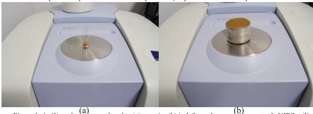
Figura 1. Análises de amostras de solos (a) em pó e (b) indeformada em equipamento de NIRS utilizado no experimento (Perkin-Elmer, modelo Spectrum 100N, utilizando o acessório NIRA).
