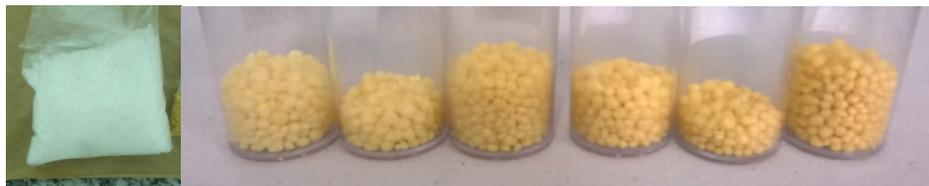
Figura 4. Ureia sem revestimento e após revestimento com PU, respectivamente.
