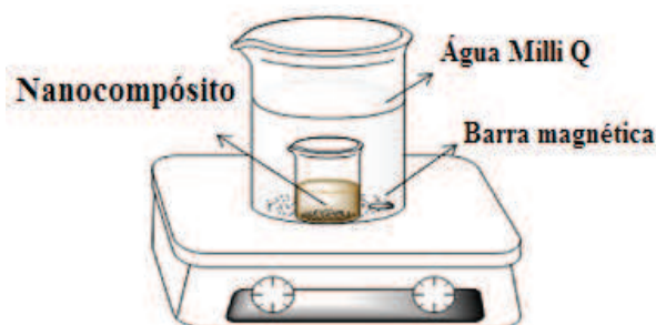
Figura 1. Sistema utilizado para retirar as alíquotas para as medidas de dessorção de ureia.
