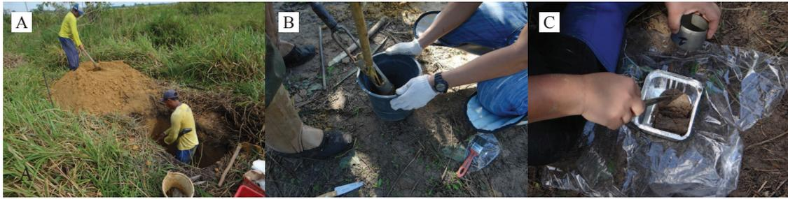
Figura 2. A - Abertura das trincheiras; B - Coleta de solo com trado holandês; C - Amostras indeformadas para densidade.
