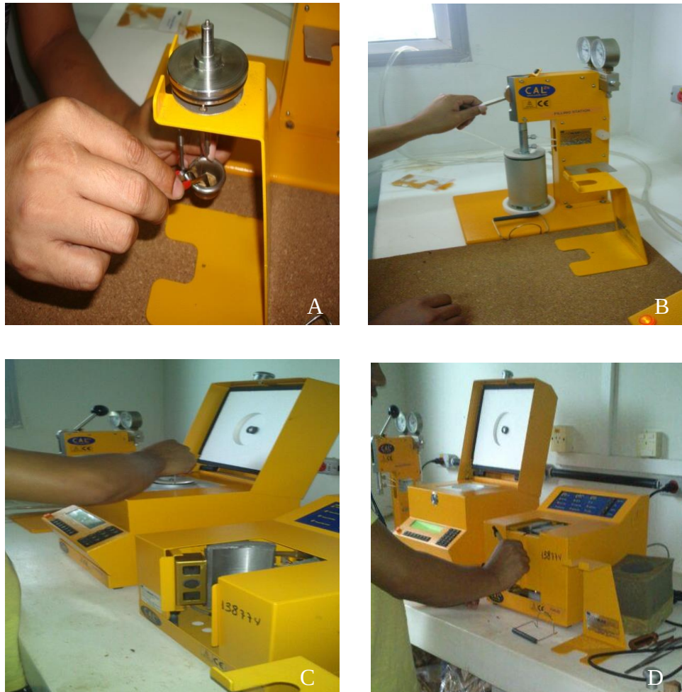
Figura 10 - Análise do poder calorífico através da bomba calorimétrica, utilizando grãos de madeiras secas (Figura 10A) pelo enchimento da bomba (Figura 10B), leitura no calorímetro (Figura 10C) e esfriamento da bomba (Figura 10D).
