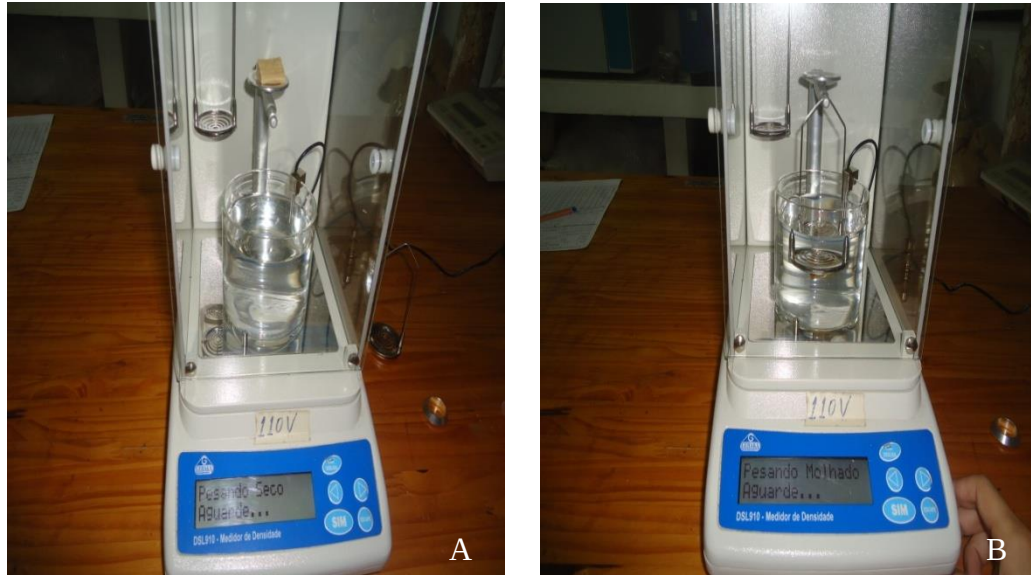
Figura 9 - Determinação da densidade básica através do densímetro digital pela mensuração do peso seco (Figura 9A) e peso molhado da amostra (Figura 9B), utilizando líquido como referência.
