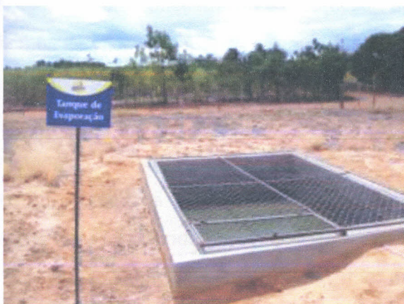
Figura 1 – Tanque de Evaporação
