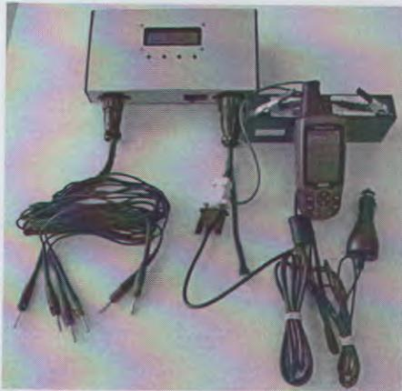
Figura 4. Ilustração do sistema protótipo de medida de condutividade elétrica do solo.
