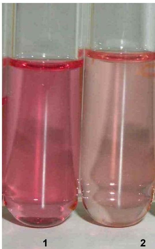
**Figura 11** - Quantificação de AIA utilizando o reagente de salkowski: diferentes tons de rosa na quantificação de AIA. O tom rosa escuro evidencia a maior concentração de AIA. Amostra **1** -16R3 ; **2** – 12R3/B2.
