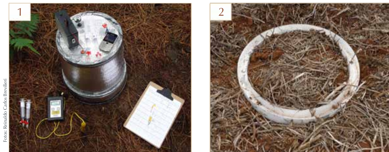
Figura 3. (1) Câmara estática acoplada no ato da coleta das amostras de ar no solo cultivado com Pinus taeda ; (2) Base ou canaleta metálica inserida no solo.
