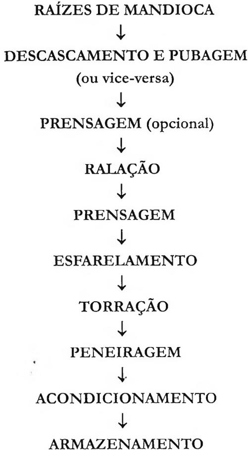
Fig. 34. Fluxograma do processamento de farinha d'água de mandioca.
