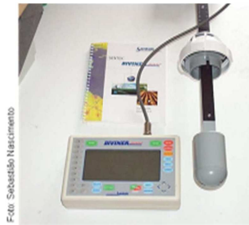
Figura 3. Equipamento utilizado no monitoramento do teor de água no solo DIVINER 2000 – Sentek: mede a umidade do solo a cada 10 cm.
