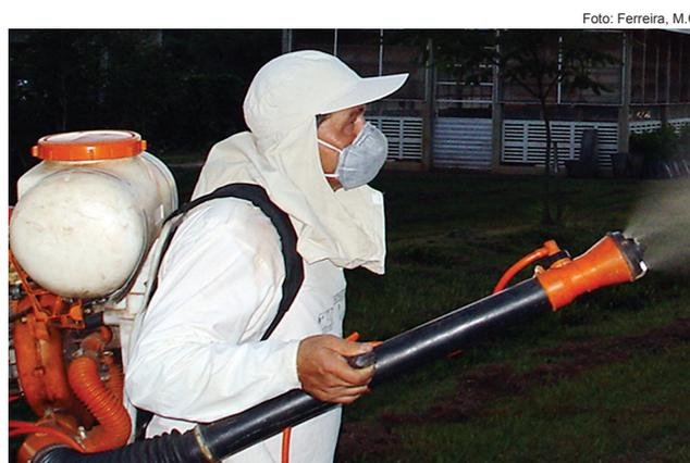
Figura 3. Aspecto da utilização de um pulverizador costal motorizado
