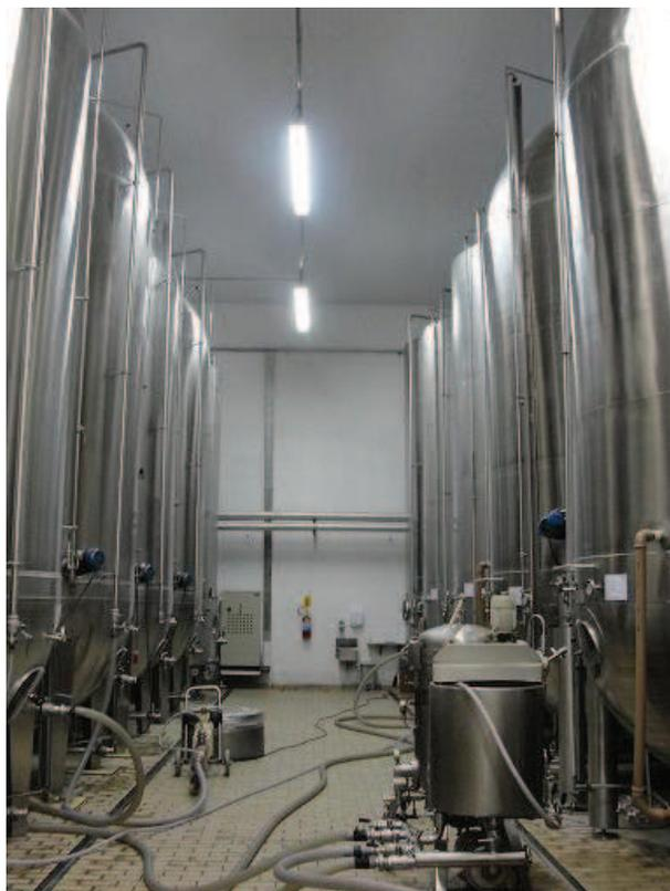
**Figura 5.** Ambiente ideal para a elaboração de vinhos e derivados, onde o piso é impermeável, antiderrapante e de fácil higienização, as luminárias possuem proteção, a fiação elétrica está embutida e o teto possui forro e visivelmente não tem aberturas que facilitem a entrada de pragas e insetos.
