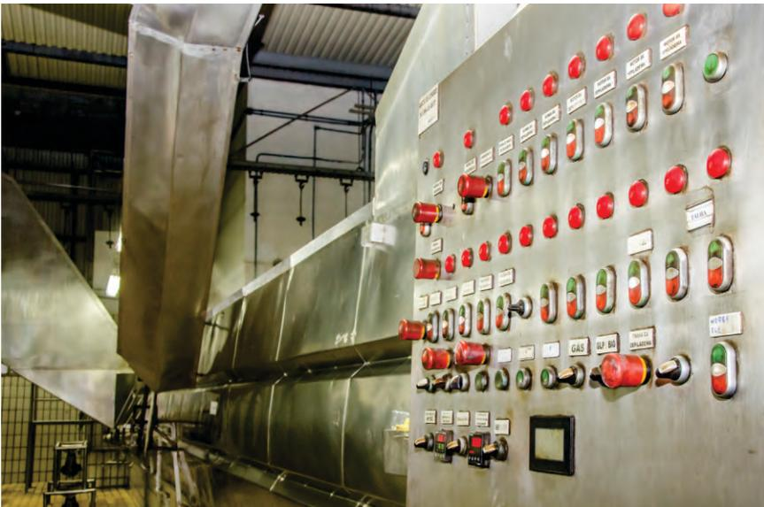
**Figura 8.** Equipamento de escaldagem, em que a carcaça fica de dois a cinco minutos.
