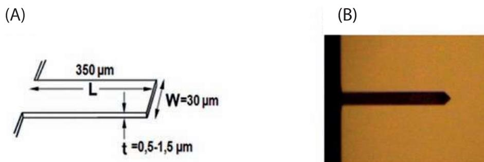
**Figura 7.** (A) Diagrama esquemático dos parâmetros geométricos do microcantiléver; (B) imagem do microcantiléver de silício retangular.
