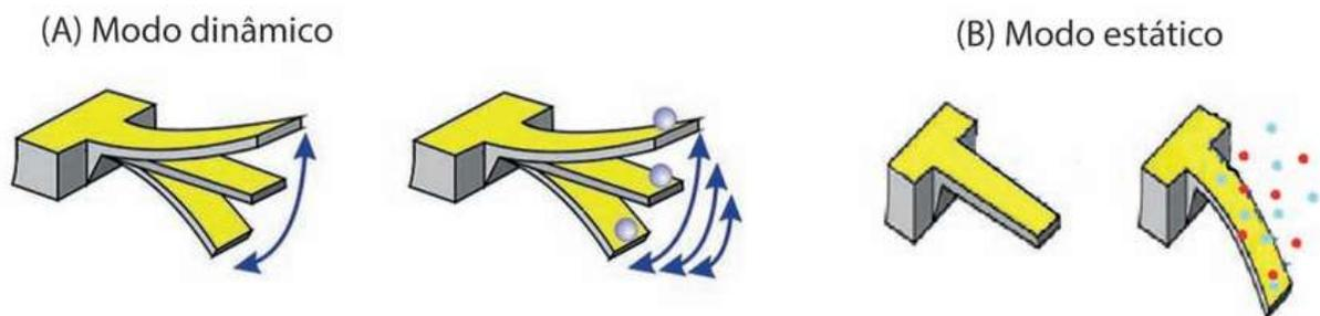
**Figura 6.** Representação esquemática dos dois modos de operação do microcantilêver (TABBARD-COSSA, 2005), A) mudança da fres devido à mudança da massa efetiva e B) tensão superficial devido à adsorção de moléculas.
