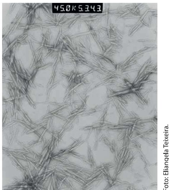
**Figura 7.** Nanofibras de celulose obtidas da hidrólise ácida de fibras de algodão.
