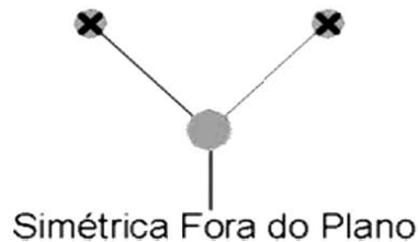
Figura 4. Modos de vibração molecular, característicos da Espectroscopia de Infravermelho. Os sinais X e • indicam movimentos para dentro e para fora do plano do desenho, respectivamente. Oscilações do eixo (estiramentos) e do ângulo (deformações) das ligações entre os átomos de um grupamento funcional.
