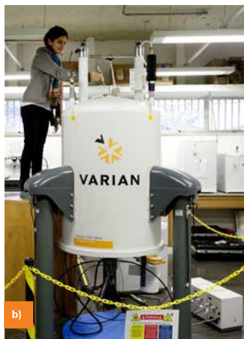
Figura 1. (a) Número de artigos científicos publicados e de citações por ano utilizando RMN para a análise de solos. Busca realizada em 29 de junho de 2015, Web of Science . (b) Equipamento de RMN instalado no Centro Brasileiro de Pesquisas Físicas (Rio de Janeiro)
