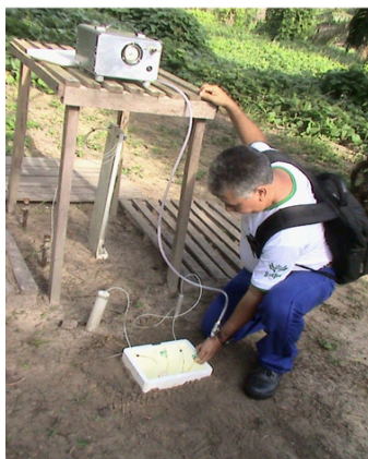
Figura 3. Foto de lisímetro instalado em campo (cortesia do Dr. Wenceslau Teixeira) e esquema de instalação de um tipo de lisímetro.
