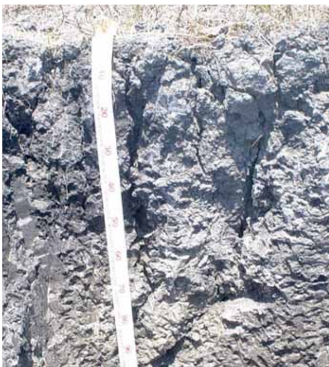
Na imagem acima observa-se um solo de textura fina com alto teor de argilas expansíveis, oriundas da alteração da rocha-mãe (basalto). A cor cinza é um indicador da ausência de ferro. (CCG)
