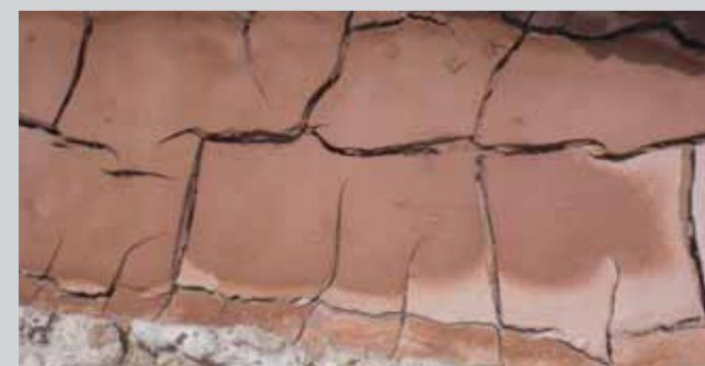
Plasticidade do solo, devido ao alto teor de argila. Departamento Central, Paraguai. (AER)
