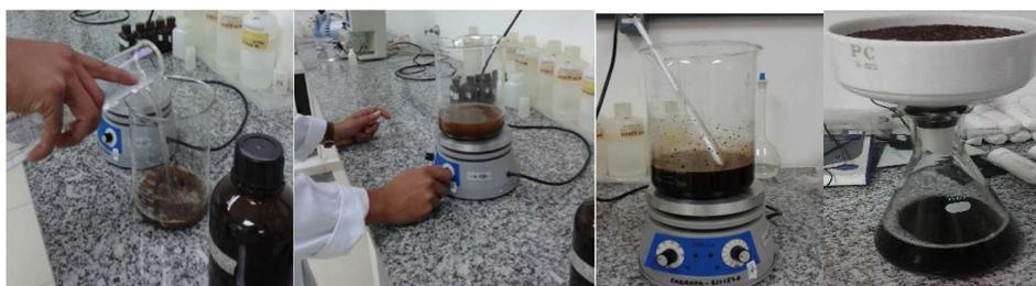
FIGURA 1. Mercerização das fibras de bocaiuva.
