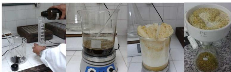
FIGURA 2. Branqueamento das fibras de bocaiuva.
