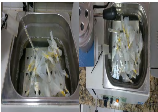
Figura – 1: Demonstração do tratamento de termoterapia de sementes de Eucalyptus grandis via calor úmido em banho – maria, mantido em uma temperatura de 55°C, estas sendo expostas a três tempos distintos, 50, 60 e 80 minutos.
