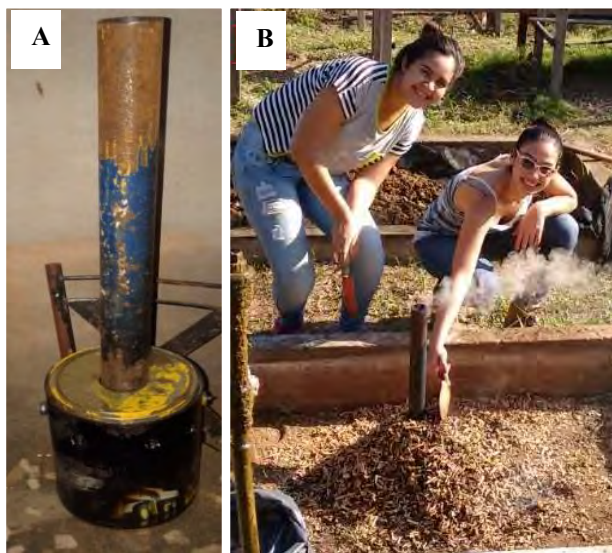
Figura 1: Carbonizador (A). Carbonização da maravalha (B).
