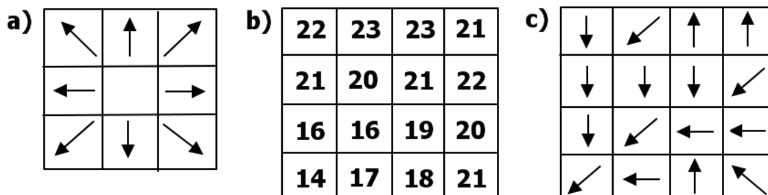
Figura 2. Modelo D8: (a) Direções possíveis de um pixel; (b) Cota de cada pixel, em metros; (c) Direção do escoamento para a célula com menor cota. Fonte: Adaptado de Turcote et al. (2001).
