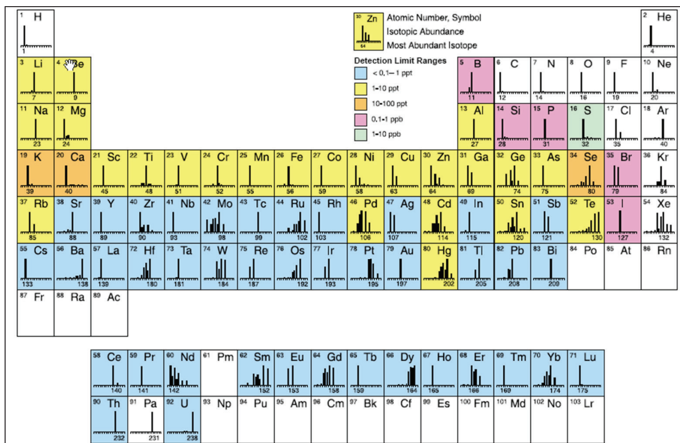
Figura 6.8 Elementos químicos e respectivos limites de detecção que podem ser analisados por um sistema de ICP-MS. Ilustração adaptada da web ( http://slideplayer.com.br/slide/1249899/ ).
