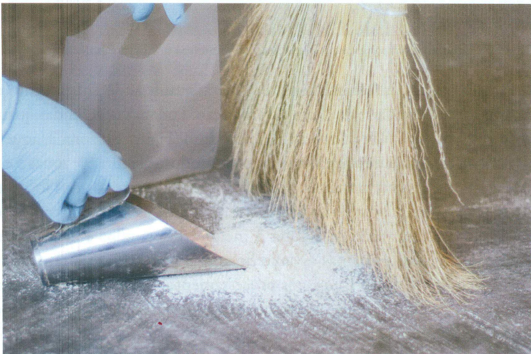
Figura 6. Coleta de amostras de varredura auxiliam a avaliar programa de limpeza.
