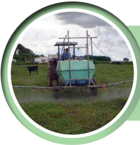
FIGURA 9.4. Aplicação da suspensão conidial de Metarhizium anisopliae em pastagem de Brachiaria decumbens , com pulverizador de barra. Foto: Marcos Valério Garcia.
