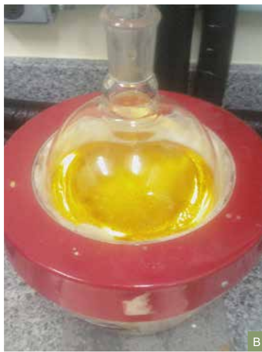
Figura 9. Processo de extração do óleo de buriti por solvente utilizando o aparelho extrator Soxhlet.
