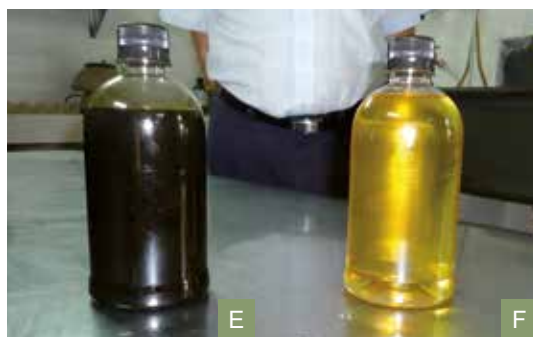
Figura 7. Fluxograma atual de processamento do coco macaúba e qualidade dos óleos obtidos: frutos de macaúba caídos no chão (A); frutos armazenados em deterioração (B); despulpamento (C); prensagem de polpa ou amêndoa (D) óleo de polpa (acidez > 60%) (E); e óleo de amêndoa (acidez > 5%) (F).
