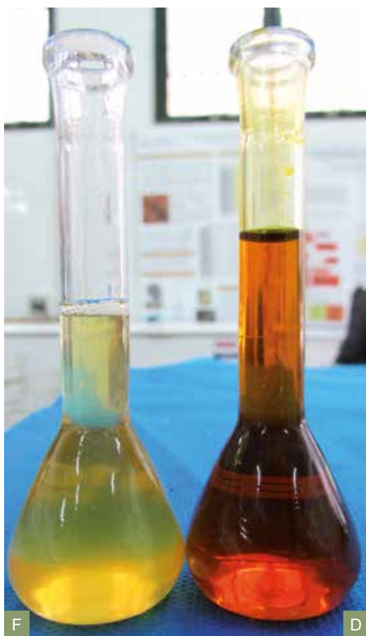
Figura 8. Fluxograma ideal para coco-macaúba e qualidade esperada dos óleos obtidos: cacho de frutos maduros de macaúba (A); frutos de macaúba colhidos do cacho (B); polpa seca de macaúba (C); óleo de polpa (acidez < 3%) (D); amêndoa (E); óleo de amêndoa (acidez < 2%) (F).
