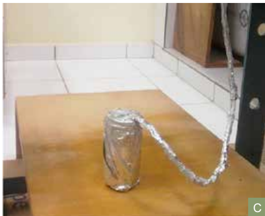
Figura 8. Extração do óleo da polpa seca do fruto de buriti por prensagem hidráulica: peças de inox do cilindro de extração (A); extração do óleo com a polpa colocada no cilindro sob pressão de 10 t (B); óleo de buriti sendo extraído em frasco volumétrico ao abrigo da luz e do ar (C); torta resultante da polpa de buriti prensada (D).
