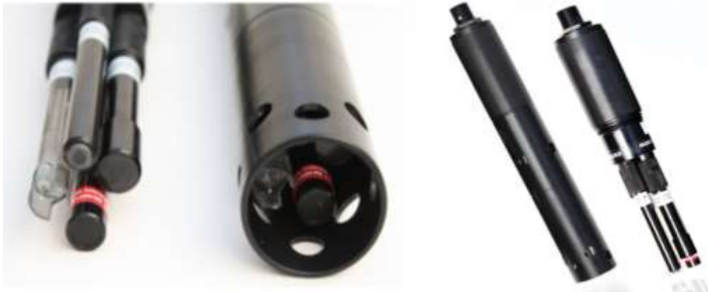
Figura 3. Sonda multiparâmetro aquaread AP 2000. Fonte: www.agsolve.com.br (2014).
