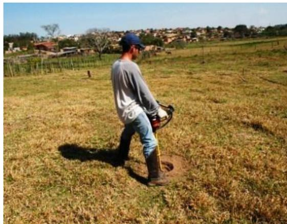
**Figura 51.** Perfurador motorizado usado para perfurações de solo ou abertura de covas. Fotos: Arquivo da Alibaba
