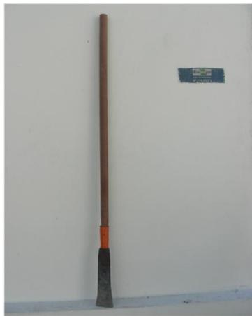
**Figura 50.** Instrumento cavador de uso manual para abertura de covas, confeccionado geralmente a partir de uma foice quebrada. Foto: Vicente de Paula Queiroga
