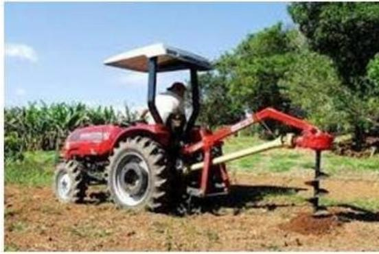
**Figura 86.** Perfurador acoplado ao trator para perfuração de solos ou abertura de covas.
