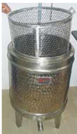
Figura 6. Processo de branqueamento consiste em imergir o pequi em água fervendo no tanque por 5 minutos. Foto: Luis Roberto Carrazza e João Carlos Cruz D'Ávila
