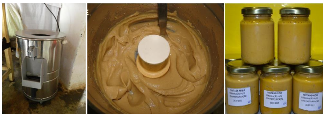
Figura 7. Despeliculadora de batatas adaptada para despolpar o pequi, homogeneização de pasta e seu envase em embalagem de vidro (Fotos: Vicente de Paula Queiroga (A); Maria Elisabeth Barros de Oliveira (B;C))
