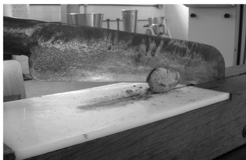
Figura 12. Guilhotina adaptada para extração da amêndoa do caroço de pequi. Foto: Ana Maria da Silva Rabêlo.
