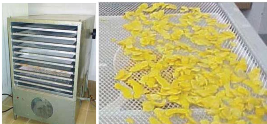
Figura 11. Desidratador elétrico usado para secagem da polpa de pequi em pedaços. Fotos: Luis Roberto Carrazza e João Carlos Cruz D'Ávila
