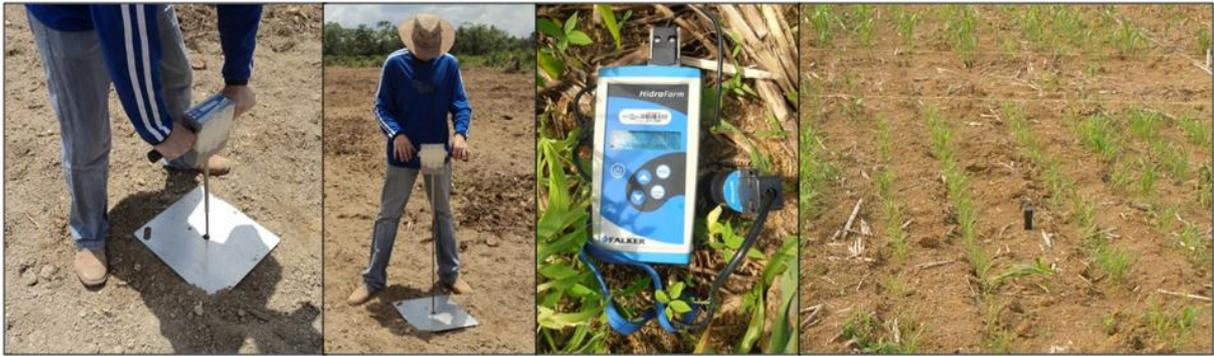
Figura 5. Demonstração das ferramentas de medida da compactação e umidade do solo. Manaus-AM, 2016.
