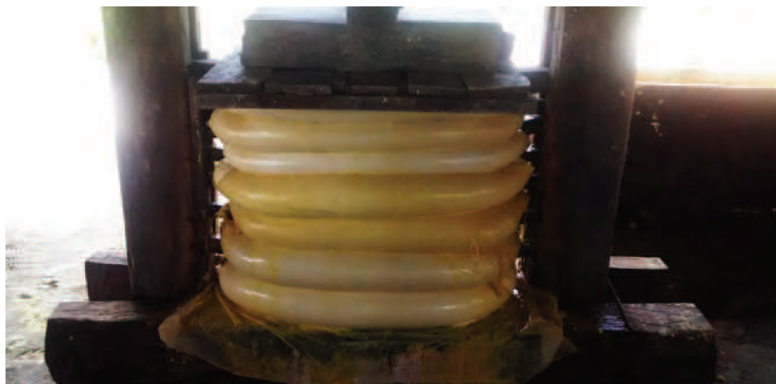
Figura 2. Prensa manual utilizada para espremer a massa da raiz de mandioca.
