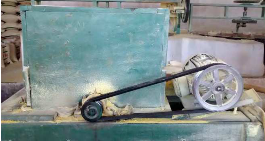
Figura 6. Triturador elétrico utilizado para esfarelar a massa prensada da raiz de mandioca.
