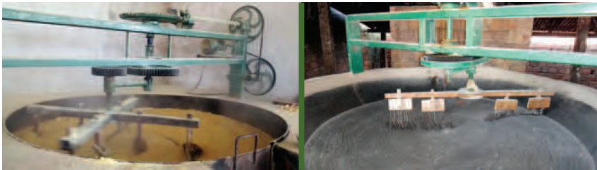
Figura 7. Fornos completos com engrenagens e motor elétrico utilizados para escaldamento e torragem da farinha de mandioca.
