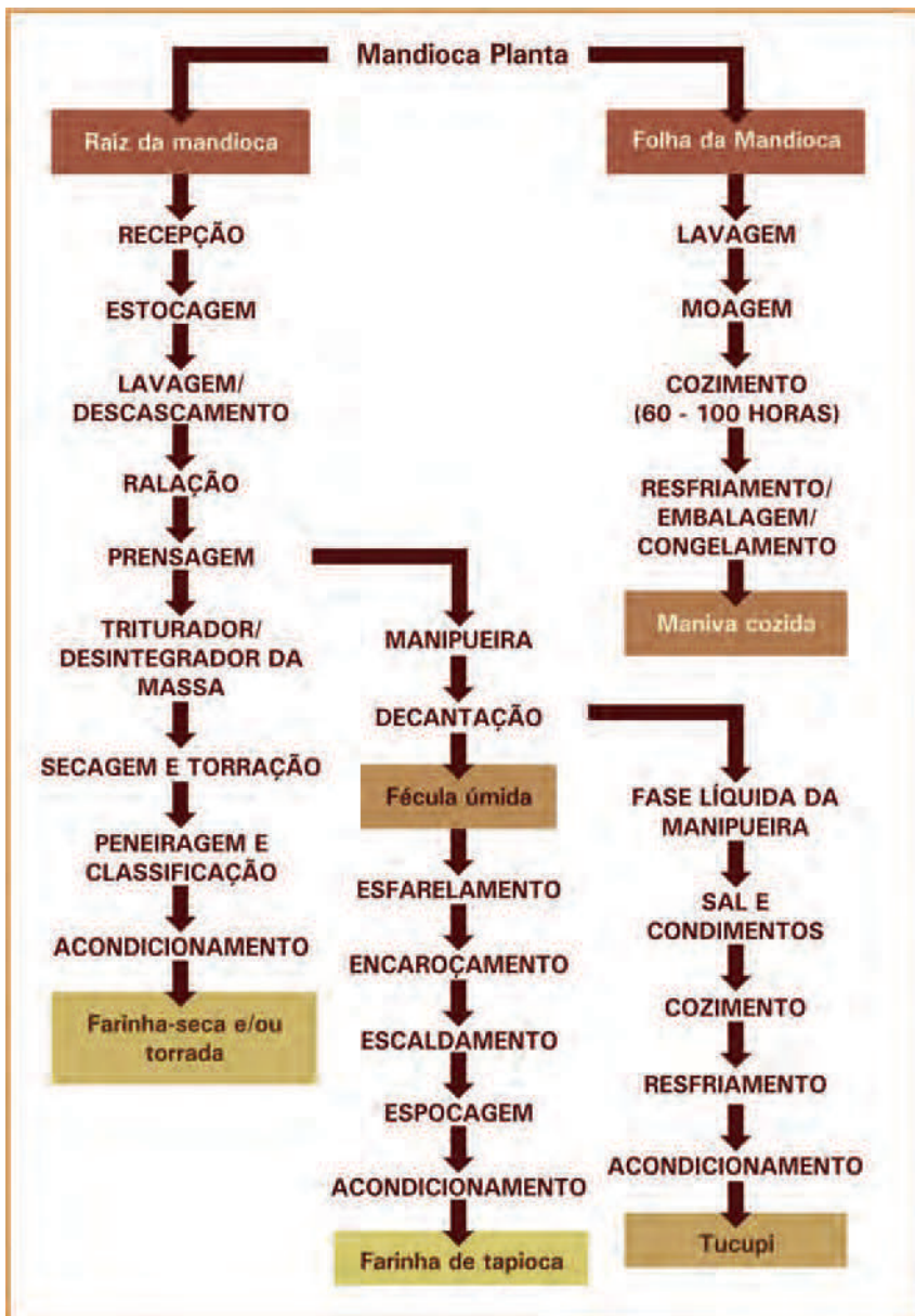
Figura 1. Fluxograma adaptado de produção para farinha-seca e farinha de tapioca, fécula, maniva e tucupi.
