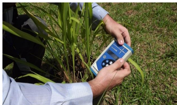
Figura 4. Leitura dos valores do Índice de Clorofila Foliar (ICF) no terço médio da folha utilizando o clorofilômetro portátil (CFL 1030 – Falker®). (Foto: Betânia M.F.S. Bacelar).
