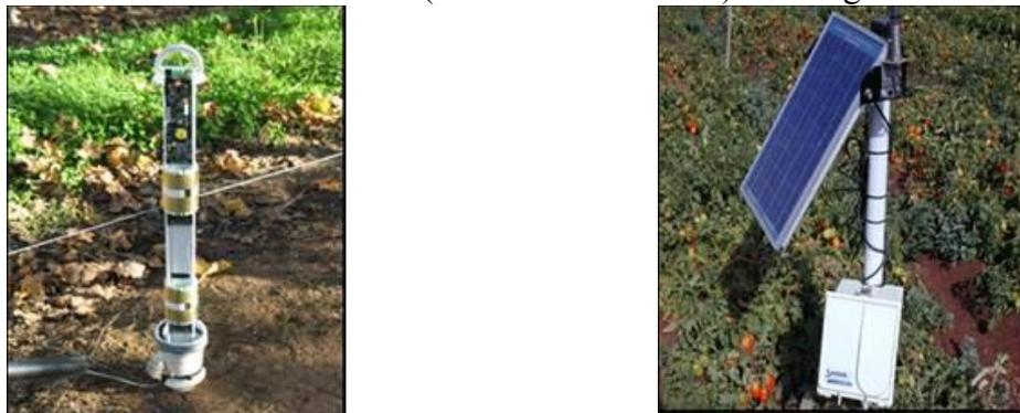
Outro fabricante é a Delta T Devices (www.delta-t.co.uk), com duas sondas perfiladoras (PR2/4 e PR2/6, variando apenas a profundidade) que funcionam de maneira similar a sonda Diviner 2000, diferindo por apresentar várias sondas em posições fixas na haste. A sonda Sentry 200 CP (Troxeer, www.troxlerlabs.com) é a mais antiga e menos atualizada nesta técnica, funcionando também de maneira similar a sonda Diviner 2000.
