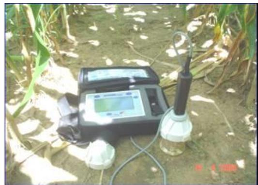
Já o modelo Enviroscan (Figura 7), consiste de uma sonda fixa permitindo o acoplamento de vários sensores em uma haste, no espaçamento desejado pelo usuário. Um total de 32 sensores pode ser acoplado ao sistema possibilitando o monitoramento do teor de água de forma instantânea. O tempo de varredura pode ser programável (1 a 999 minutos). Como dito anteriormente, uma das grandes vantagens deste modelo é que a sonda pode estar distante
