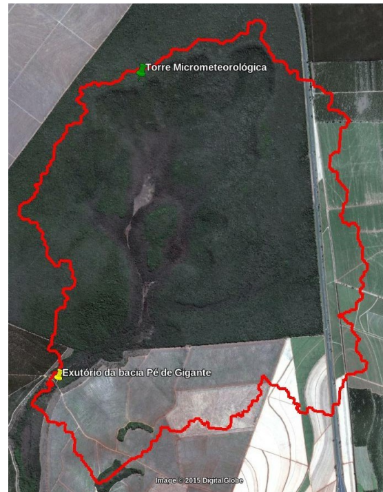
Figura 1: Delimitação topográfica da bacia hidrográfica do Córrego Paulicéia. A localização do exutório é destacada em amarelo e da torre micrometeorológica em verde. O exutório coincide com o posto de medida de vazão.
