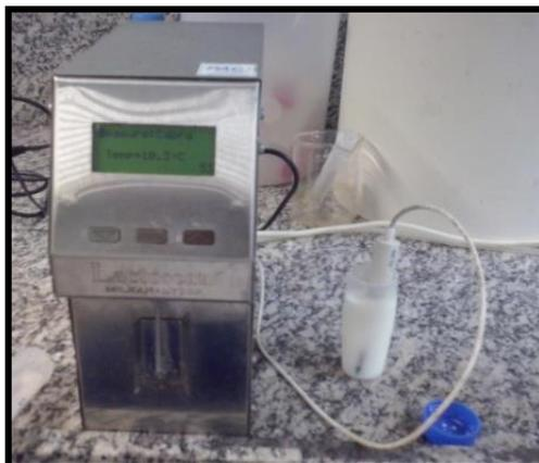
**Figura 5.** Lactoscan SA para os testes pH e CE.
