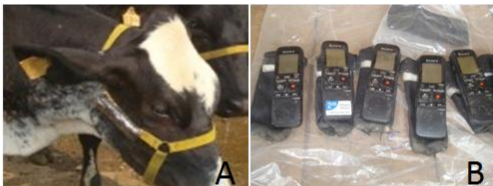
Figura 3 - Gravador de áudio acoplado em cabresto (A), gravadores de áudio (B).
