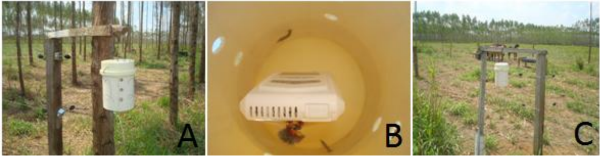
Figura 11 - Abrigo com termohigrômetro na praça de alimentação do sistema de integração Lavoura-Pecuária-Floresta (iLPF), (A); termohigrômetro dentro do abrigo (B); abrigo com termohigrômetro na praça de alimentação do sistema de integração Lavoura-Pecuária (iLP), (C).
