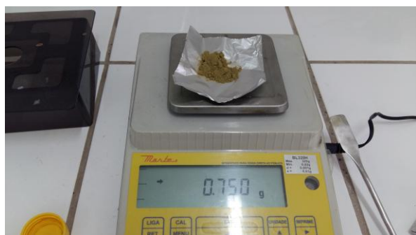
Figura 26 – Pesagem de 0,750g de amostra em balança de precisão.
