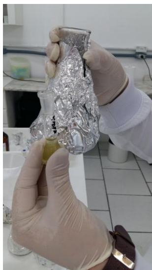
Figura 29 – 5 ml do filtrado em balão volumétrico de 25 ml.
