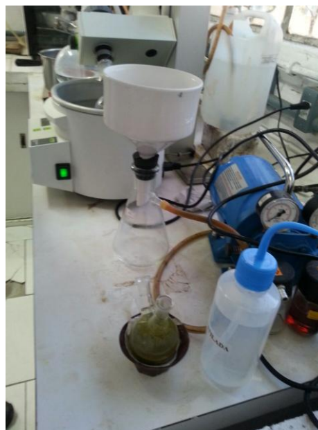
Figura 15 – Filtragem sob pressão reduzida.
