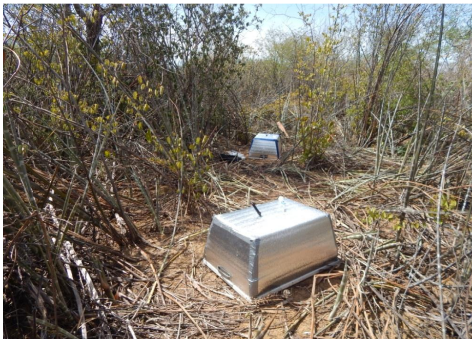
Figura 2: Câmaras estáticas utilizadas para coleta de gases de efeito estufa emitidos pelo solo em área de Caatinga Nativa, em Petrolina
