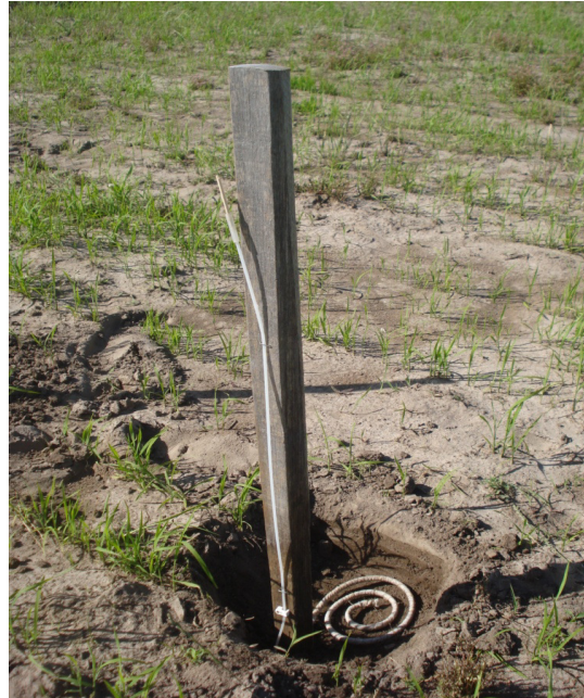
Figura 2. Vista da instalação de um extrator de solução do solo à campo.
