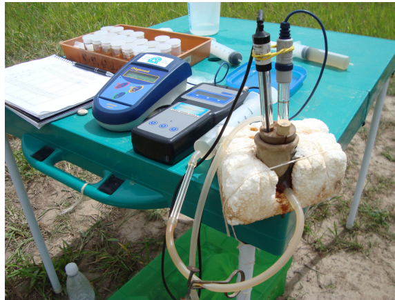
Figura 3 Vista dos equipamentos para análise de pH e Eh da solução do solo realizadas “in situ”.
