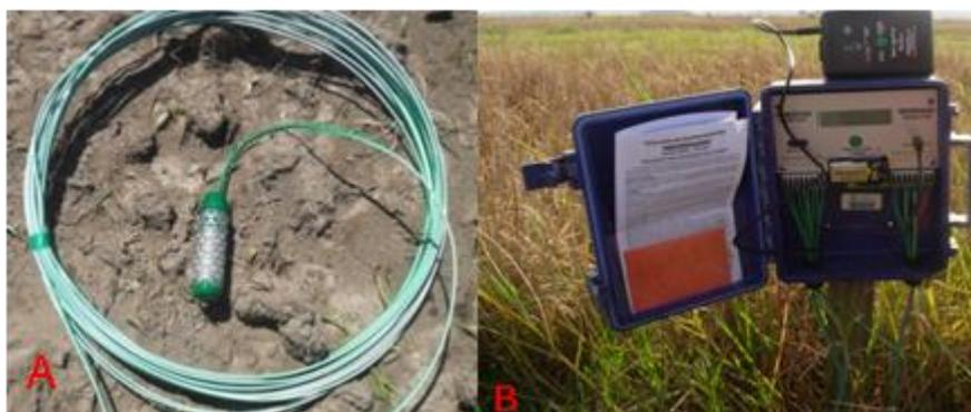
Figura 2 - Vista de sensor de tensão de água no solo do tipo *Watermark* (A) e de datalogger (B) instalados na área experimental.
